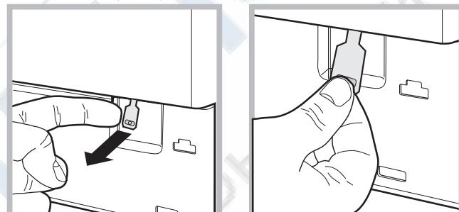
4. потяните наружу язычок, показанный на схеме, вплоть до освобождения пластикового блокировочного винта.
